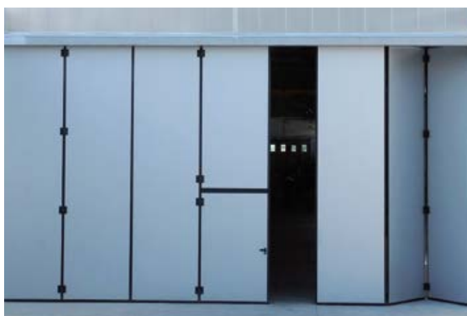
Modello 4+3 SGP ad ante multiple senza oblò, con porta pedonale per uscita di sicurezza senza scalino/ingombro inferiore, con maniglione antipanico interno.
